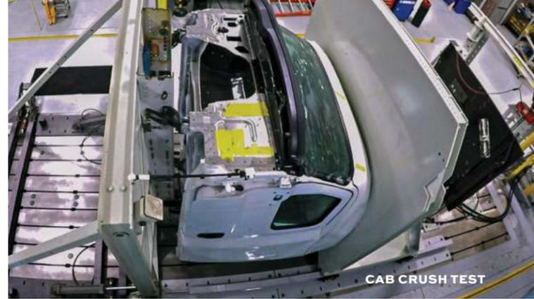
CAB CRUSH TEST
