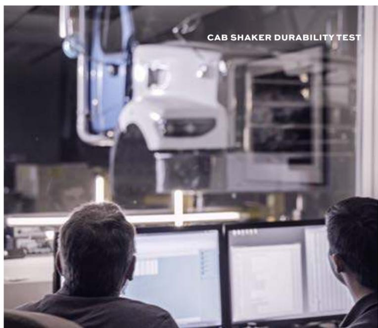
CAB SHAKER DURABILITY TEST
